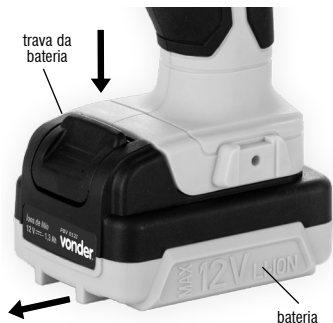
Fig. 2 – Retirando a bateria
