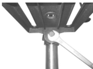
Fig. 8 – Ajuste de la inclinación de la mesa
