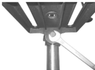
Fig. 8 – Ajuste de inclinação da mesa
