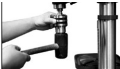
Fig. 10 – Montagem do mandril
