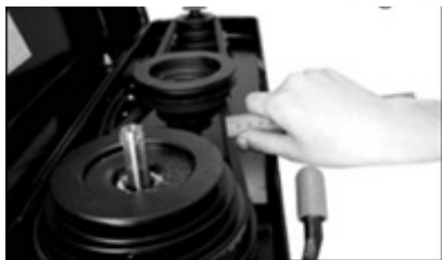
Fig. 31 – Tensión correcta de la correa
