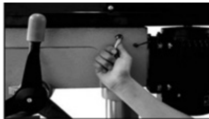
Fig. 28 – Alavanca de tensão da correia
