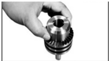
Fig. 7 – Montagem do mandril
