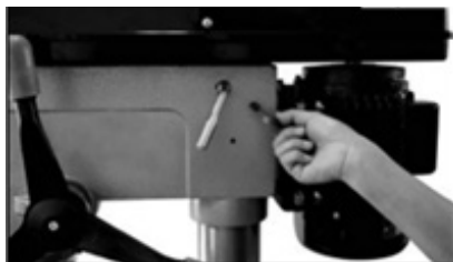
Fig. 27 – Botões de travamento da tensão da correia
