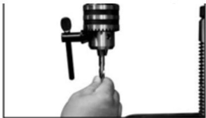
Fig. 18 – Instalação da broca
