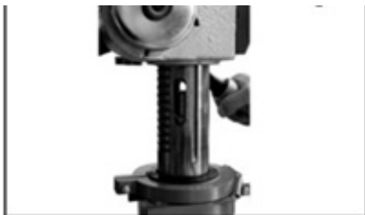
Fig. 9 – Montagem do mandril
