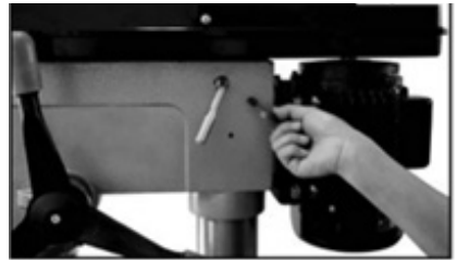
Fig. 27 – Botones de trabamamiento de la tensión de la correa
