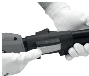
Figura 3 – Trabando el cable
