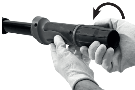
Figura 4 – Abertura do cabo
