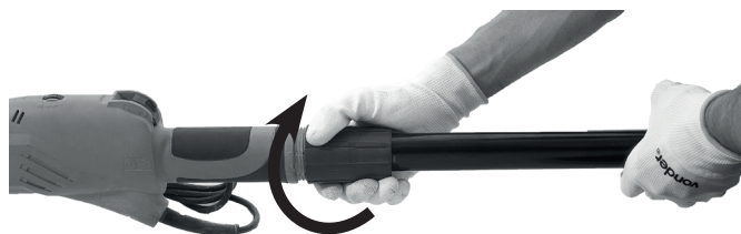
Figura 10 – Travando o sistema
