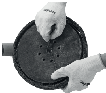
Figura 13 – Extração e instalação da base do disco
