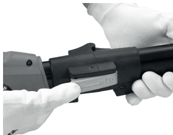
Figura 3 – Travando o cabo
