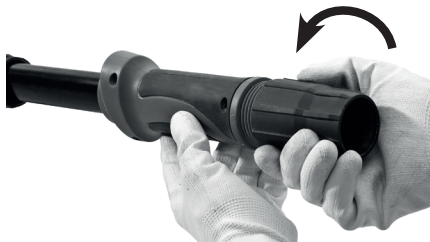
Figura 8 – Abertura del cable
