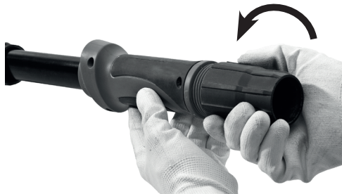
Figura 8 – Abertura do cabo
