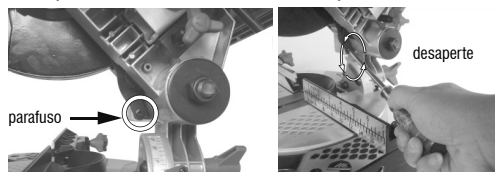
Fig. 20 – Liberação da guarda de proteção
