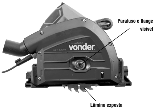
Fig. 5 – Equipamento travado no modo de troca de lâmina
