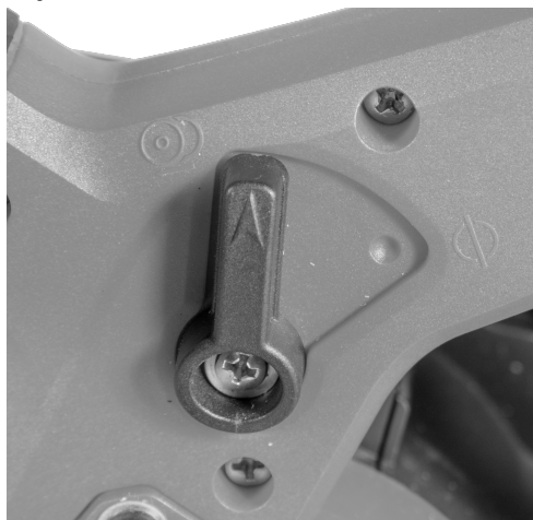
Fig. 3 – Seletor de modo na posição de mudanças da lâmina.
