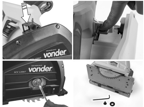
Fig. 6 – Botão trava do eixo
