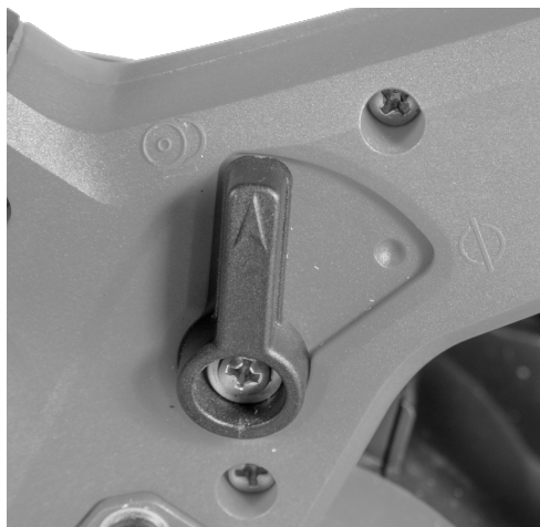
Fig. 3 – Selector de modo en la posición de cambio de la lámina.
