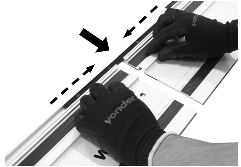
Fig. 17 – Instalando as hastes de união dos trilhos
