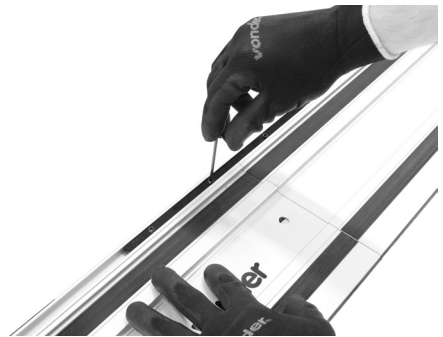
Fig. 18 – Fixando a união dos trilhos
