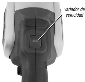
Fig. 3 – Variador de velocidad
