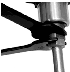
Fig. 3 - Montaje de la pala en herramienta
