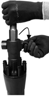
Fig. 3 – Instalação ou remoção do acessório
