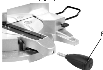
Fig. 4 – Montagem da alavanca de ajuste da mesa
