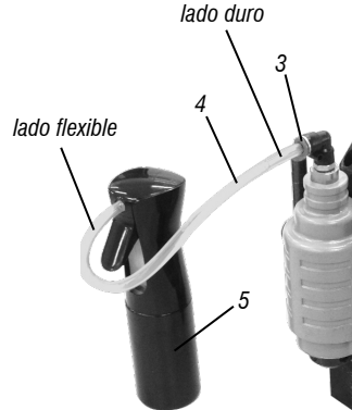
Fig. 4 – Recipiente de líquido de corte, manguera de lubricación y conector rápido
