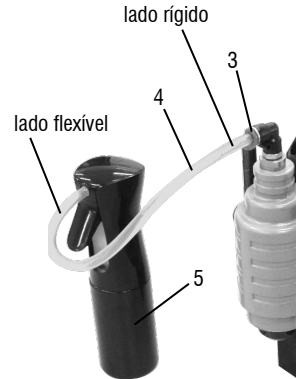
Fig. 4 – Recipiente de fluido de corte, mangueira de lubrificação e conector rápido
