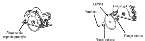
Fig. 4 – Instalação ou extração da lâmina de serra
