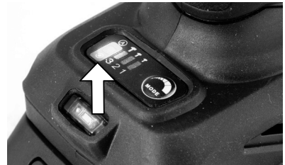
Fig. 6 – Parada de reversión automática
