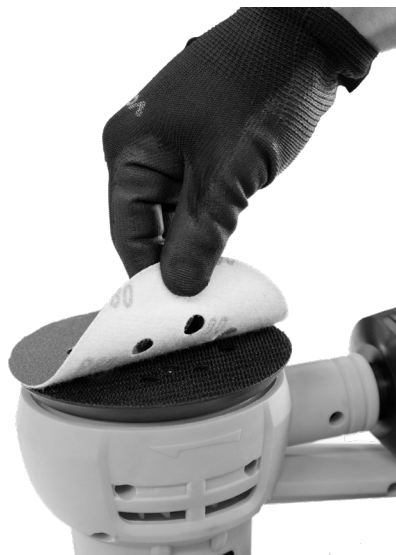
Fig. 3 – Extração da lixa
