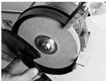
Fig. 4 – Retirando a tampa de segurança
