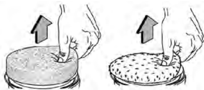
fig.4 – desenho demonstrativo para a extração do equipamento para polimento
