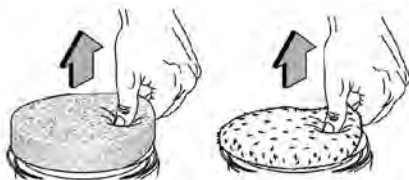
fig. 4 – dibujo demostrativo para desmontaje del accesorio para el pulido
