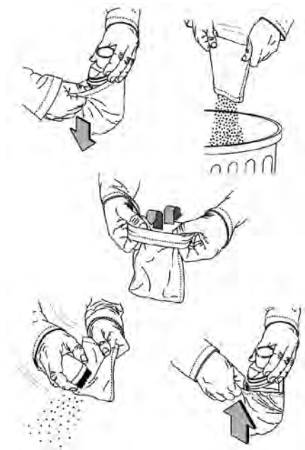
fig. 7 - dibujo demostrativo para limpieza del recipiente
