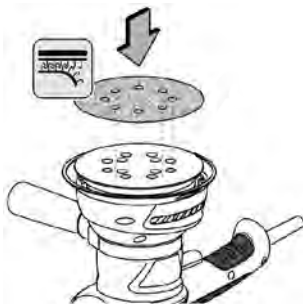
fig. 1 – desenho demonstrativo da fixação da lixa
