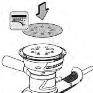
fig. 1 – dibujo demostrativo para montaje de la lija
