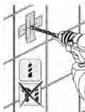
fig. 6 - perfuração em cerâmicas esmaltadas (porcelanato)
