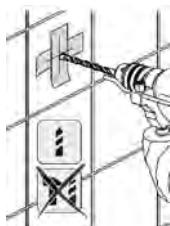
fig. 6 – perforación en cerámicas esmaltadas (porcelanato)
