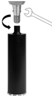
Fig. 2 – Instalación de la corona diamantada
