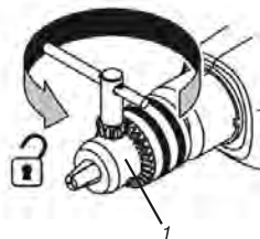
fig. 2 – dibujo demostrativo para soltar la broca
