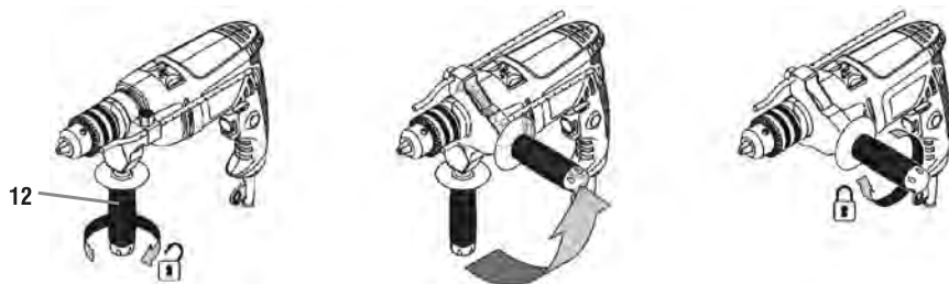
fig. 4 – ajustando la empuñadura auxiliar
