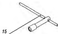
fig. 9 – llave para soltar la cuchilla
