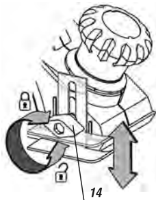
fig. 3 – ajuste de la altura de la guía lateral
