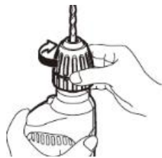
Fig. 4 – Demonstrativo para soltar o mandril de aperto rápido
