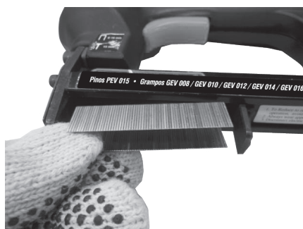
Fig. 4 - Posicionamiento de los clavos/grapas
