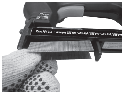
Fig. 4 – Posicionamento dos pinos/grampos
