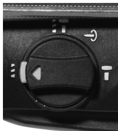
Fig. 4 – Posição para perfuração sem impacto
