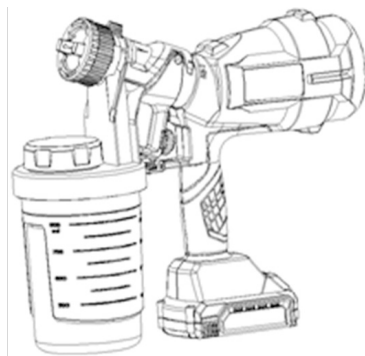
Fig. 4 – Fixando o reservatório na pistola
