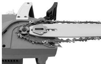
Fig. 5 – Instalação da corrente no pinhão e sabre no parafuso guia
