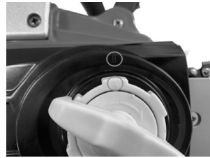
Fig. 6 – Alineación de la cubierta y botón de ajuste
