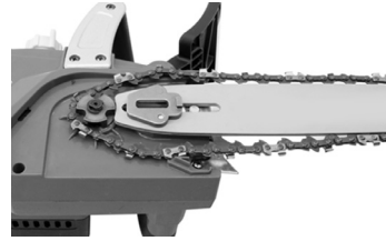
Fig. 5 – Montaje del sable y cadena de corte
