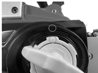
Fig. 6 – Alinhamento da tampa e botão de ajuste
