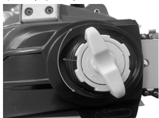
Fig. 8 – Botão de ajuste de tensão da corrente
