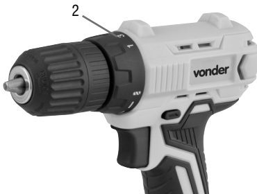
Fig. 6 – Ajuste del torque
