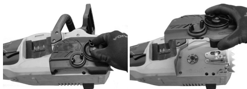
Fig. 5 – Removiendo la cubierta de protección
