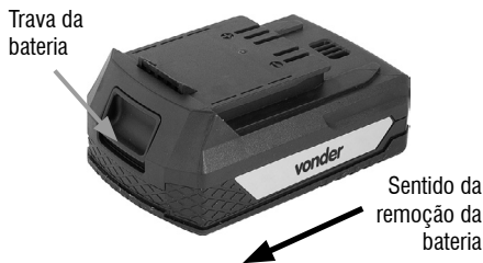
Fig. 3 – Retirando a bateria
