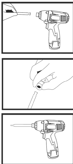
Fig. 3 – Instalação do Bits
