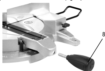
Fig. 4 – Instalación de la traba de la mesa
