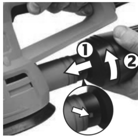
Fig. 4 - Montagem e desmontagem do coletor de poeira
