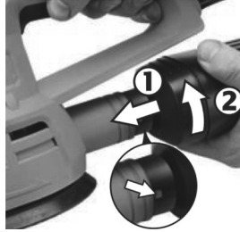
Fig. 4 – Montaje y desmontaje del colector de polvo
