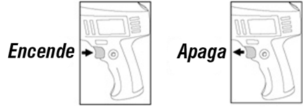
Fig. 3 – Interruptor de accionamiento
