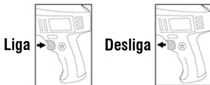
Fig. 3 – Interruptor de acionamento
