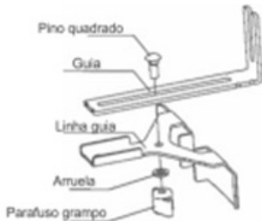
Fig. 5 – Fresando com guia reta
