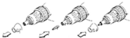
Fig. 2 – Instalación y sustitución del bits/punta
