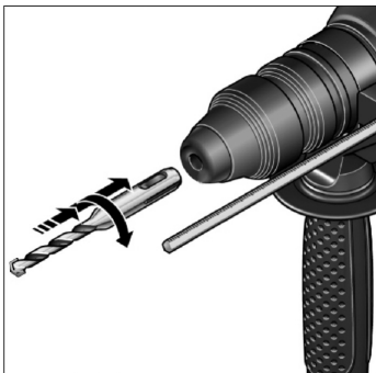
Fig. 2 – Desenho demonstrativo para instalação do acessório
