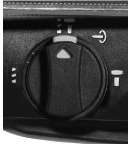
Fig. 5 – Posição para perfuração com impacto
