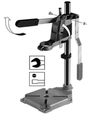
Fig. 3 – Fijación de la palanca a la base móvil del cabezal
