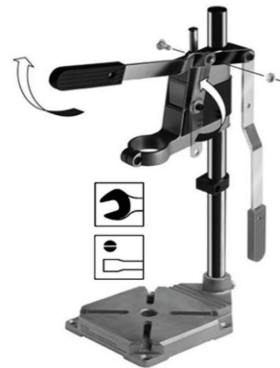
Fig. 3 – Fixação da alavanca na base móvel do cabeçote
