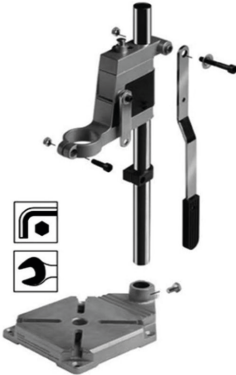
Fig. 2 – Montagem da alavanca, cabeçote, batente, guia tubular e base
