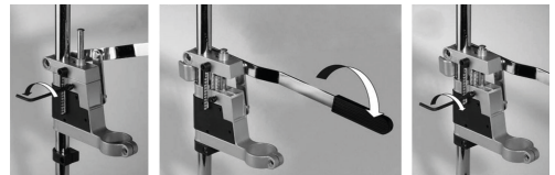
Fig. 4 – Aperto do parafuso hexagonal
