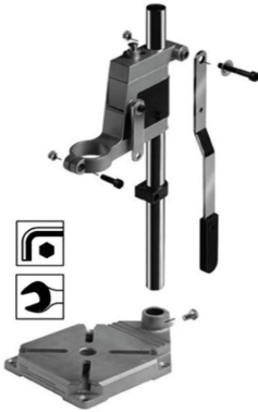
Fig. 2 – Montaje de la palanca, cabezal, tope, guía tubular y base
