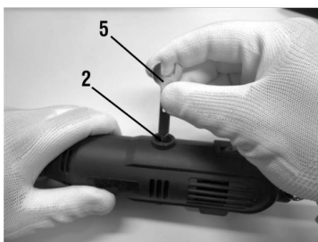
Fig. 6 – Sustitución de cepillo carbón
