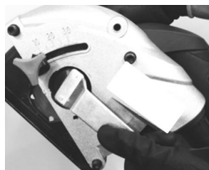
Fig. 4 – Extraindo a flange com a chave 2 pinos
