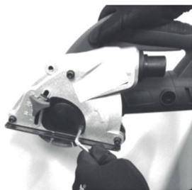
Fig. 2 – Retirando la tapa del eje (5)
