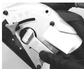
Fig. 4 – Extrayendo la brida con la llave de 2 pines
