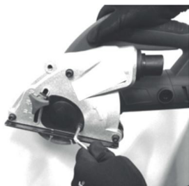
Fig. 2 – Retirando a tampa do eixo (5)
