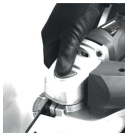
Fig. 3 – Acionando o botão trava do eixo
