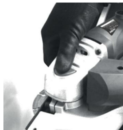
Fig. 3 – Accionando el botón de bloqueo del eje
