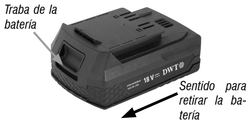
Fig. 5 – Retirar la batería
