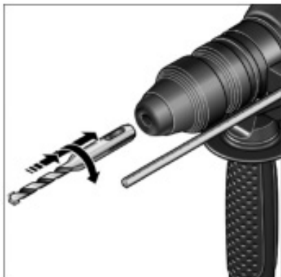
Fig. 2 – Desenho demonstrativo para instalação do acessório Para remover o acessório, puxe e segure o mandril (1) e puxe o acessório para frente (Fig. 3). Todos os acessórios devem ser limpos após a utilização.
