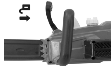
Fig. 15 – Liberación manual del freno
