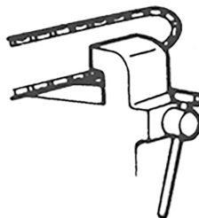
Fig. 24 – Fixação da motosserra
