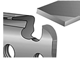
Fig. 30 – Redondeando el salto de corte
