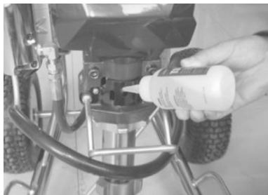
Fig. 9 – Lubricación de la máquina
