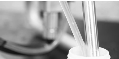
Fig. 33 – Añadir aceite para el almacenamiento
