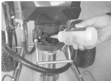
Fig. 9 – Lubrificando a máquina
