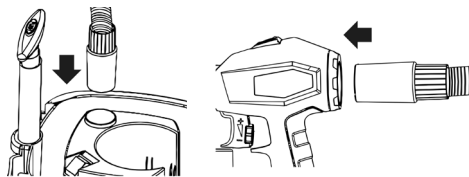
Fig. 3 – Conexão da mangueira
