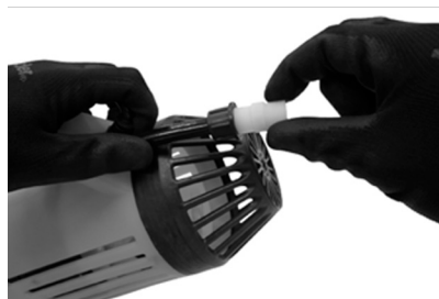
Fig. 2 – Instalando o nipple de entrada
