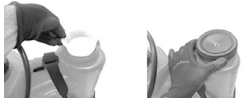
Fig. 12 – Verificación e instalación del colador
