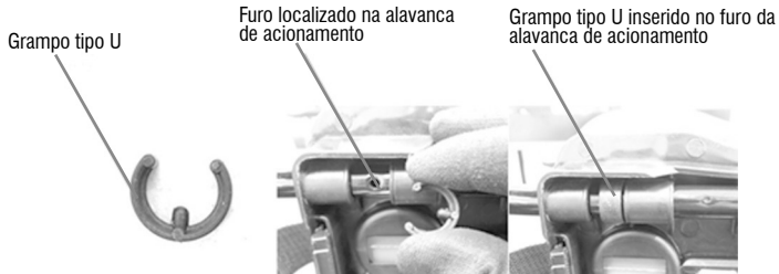
Fig. 4 – Inserindo o grampo tipo U no furo da alavanca de acionamento
