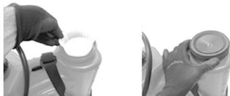
Fig. 12 – Verificação e instalação da peneira
