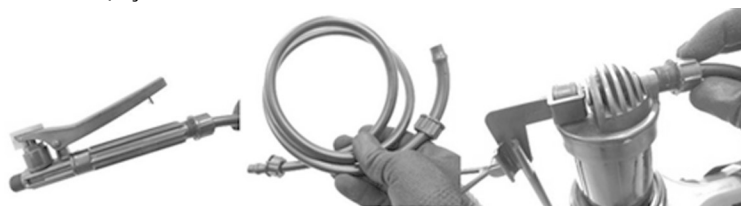
Fig. 8 – Instalação da mangueira
