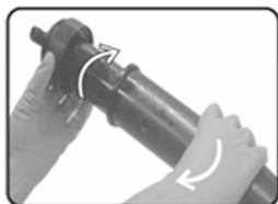
Fig. 15 – Liberación de la cámara de compresión del cilindro
