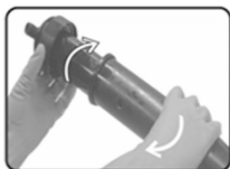
Fig. 15 – Liberando a câmara de compressão do cilindro
