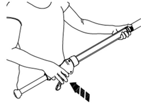
Fig. 9 – Adicionando tinta no rolo
